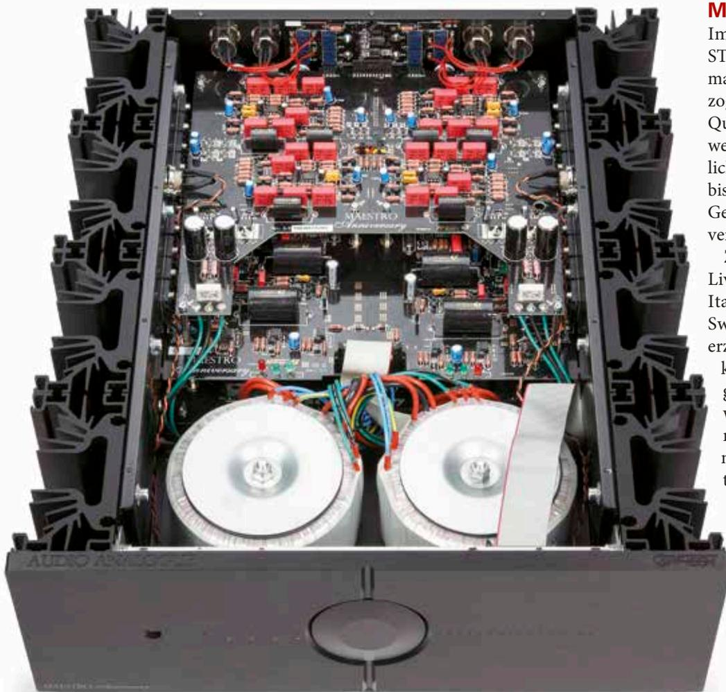
▲ Zwei potente Ringkerntrafos künden vom Doppel-Mono-Aufbau. Im Verein mit den Glättungskondensatoren versorgen sie ein vollsymmetrisches Verstärkerkonzept ohne Über-Alles-Gegenkopplung.
